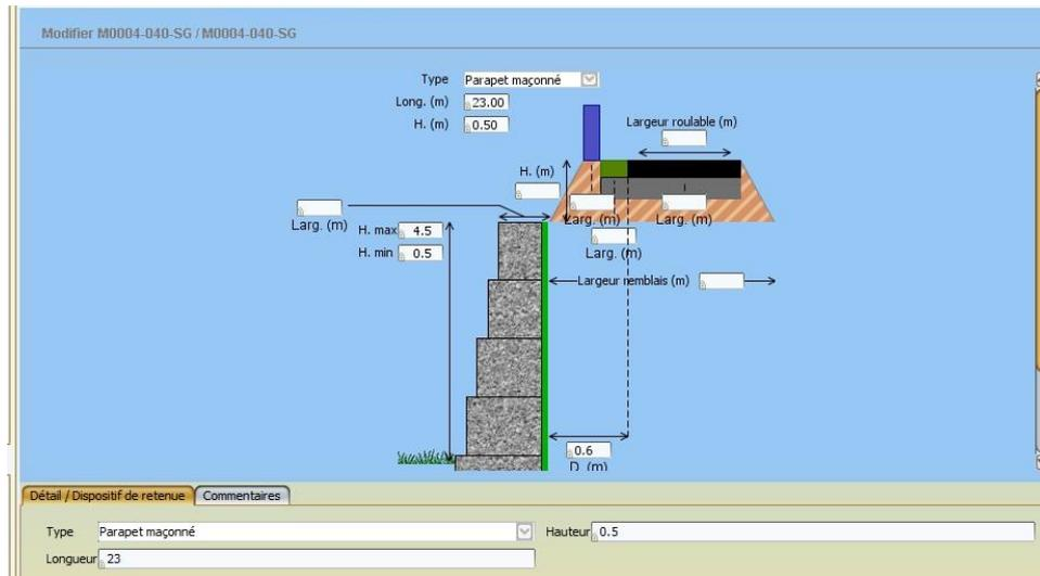
*Profil en travers - Mur gabions soutenant une voie en remblai
