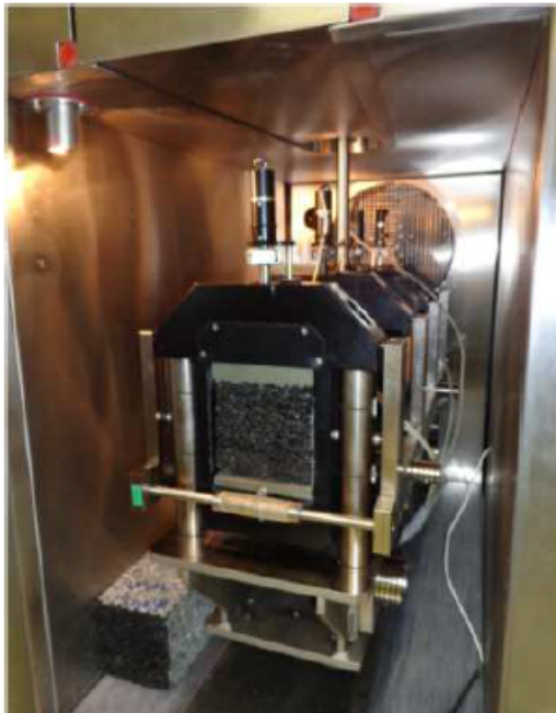
Figure 3. Banc de fatigue 4PB à Epsilon. Figure 4. Principe de l'essai 4PB.
