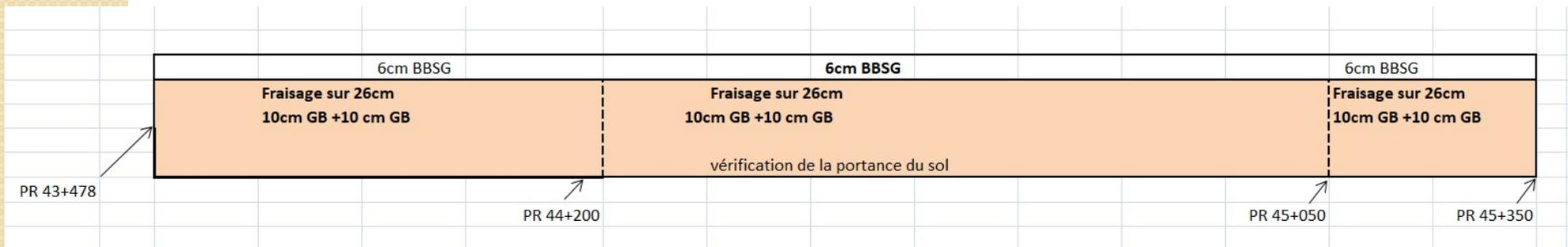
Fraisage sur 26cm, vérification de la portance de la plateforme, Mise en œuvre en 2 couches de GBcl3 et revêtement en BBSG 0/10
