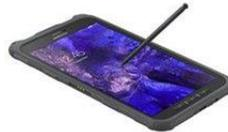
Le système OKAPI fonctionne sur une tablette sous ANDROID 5.0 et suivantes de type Samsung Galaxy Pro 10.1' (compatible Ethernet) avec un adaptateur Ethernet, ou tablette durcie Samsung Galaxy Tab Active (SM-T365) 16 giga - écran de 8 pouces.
