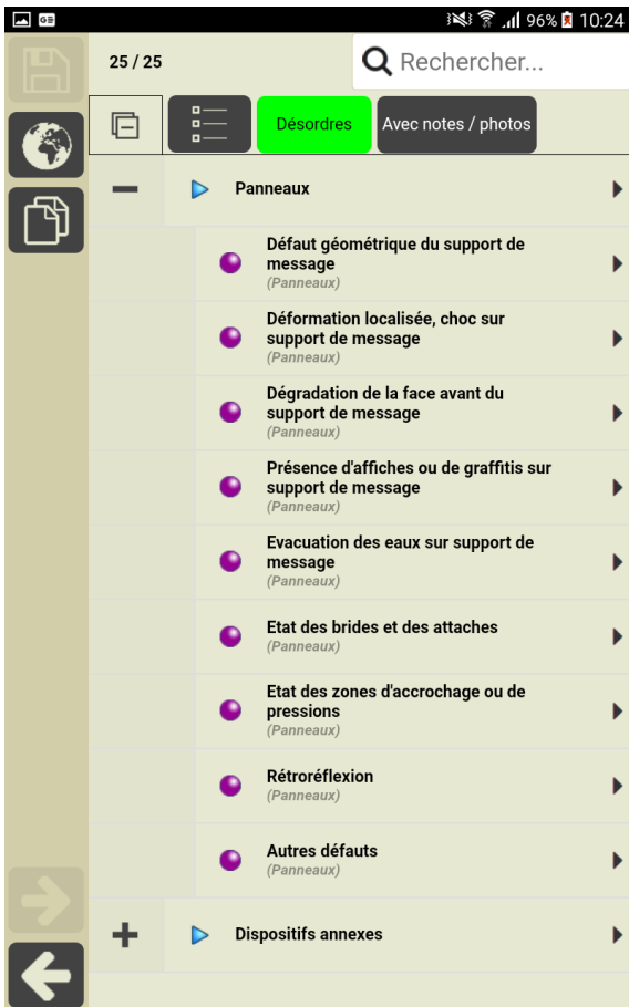
Les désordres des Panneaux
