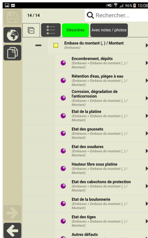
Les désordres d'une Embase
