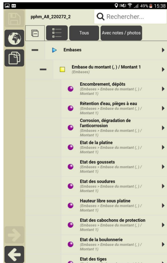
Les désordres d'une Embase
