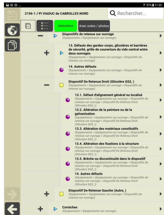
Désordres des dispositifs de retenue
