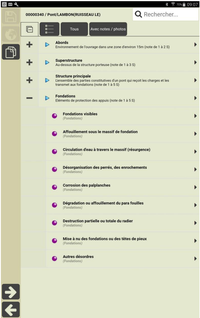
Les désordres des fondations
