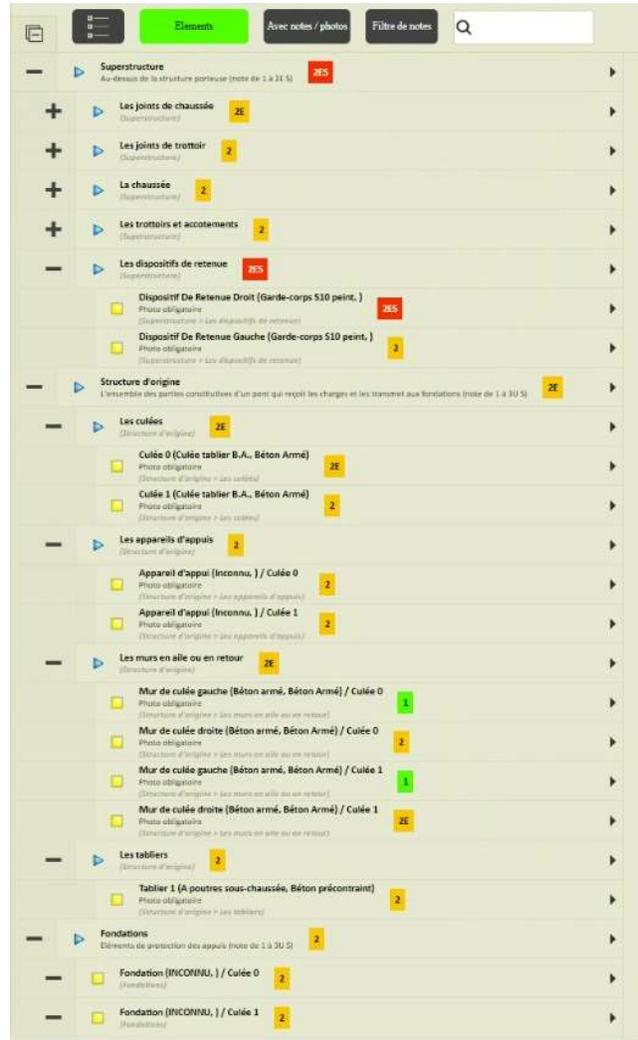
Notation des éléments d'un pont à tablier
