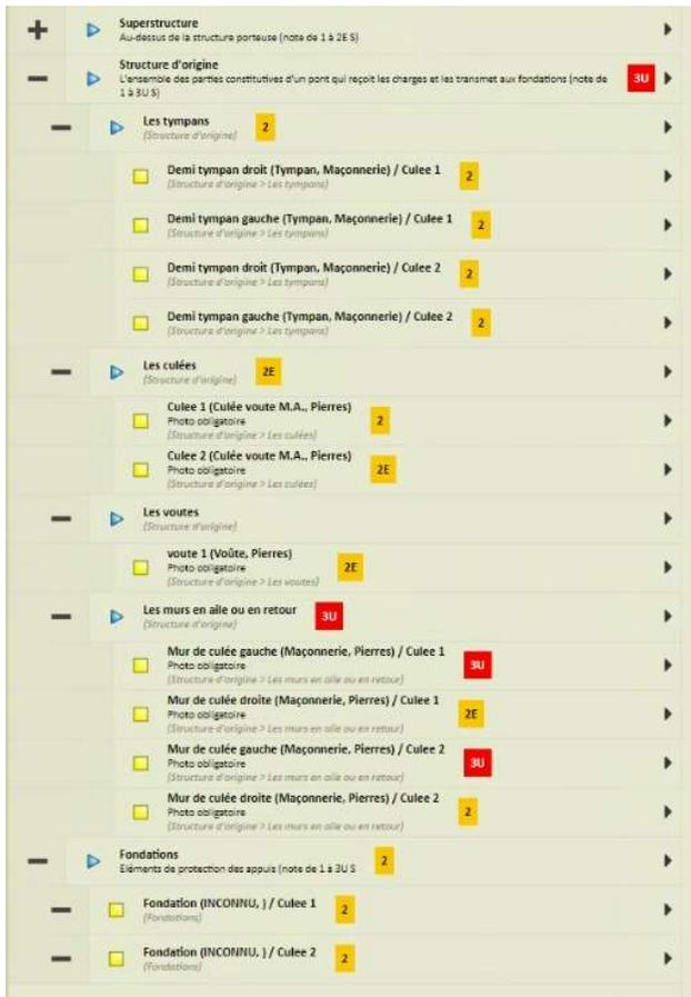
Notation des éléments d'un pont Voûte
