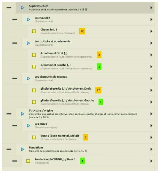
Les éléments d'un pont Buse
