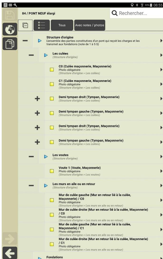
La structure d'origine d'un « Pont voûte »
