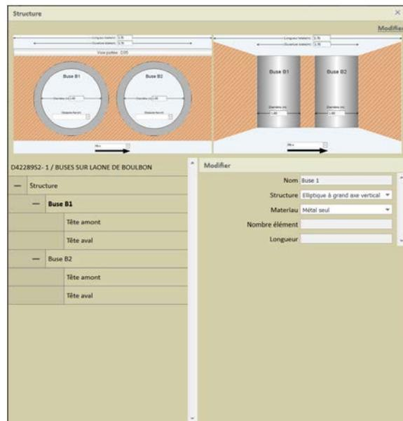
Structure d'un pont « Buse » - Exemple
